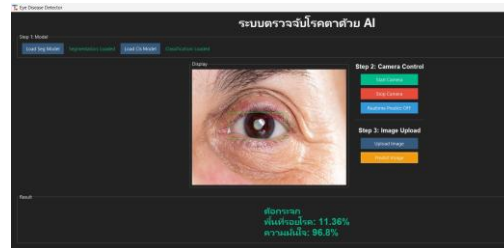
ภาพที่ 9 การทำงานของ GUI และการคำนวณพื้นที่รอยโรค
