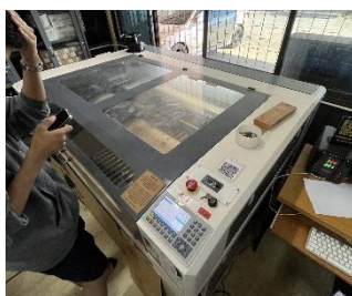
รูปที่ 11 เครื่องตัดเลเซอร์ขณะกำลังตัดโครงปลั๊กอะคริลิก
