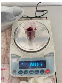
(ภาพที่ 5 ภาพของวัสดุตอนหลังดูดซับเลือดเทียม และชั่งน้ำหนัก)
