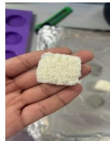
(ภาพที่ 3 ภาพของวัสดุห้ามเลือดตอนเสร็จสมบูรณ์แล้ว มีความยืดหยุ่นและนุ่มเหมือนฟองน้ำ)
