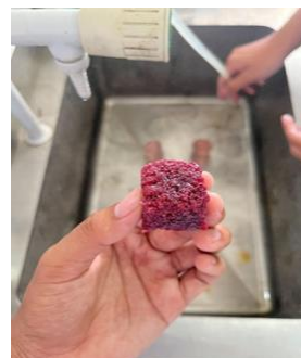
(ภาพที่ 4 ภาพของวัสดุตอนดูดซับเลือดเทียม)
